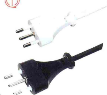
D08 意大利插头 Italy plug 10A 250V~ H05VV-F 3G0.75~1.0mm 2 H03VV-F 3G0.75mm 2
