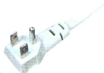
YY-3B 美式插头 American plug E137398 SPT 18、16AWG × 3C
