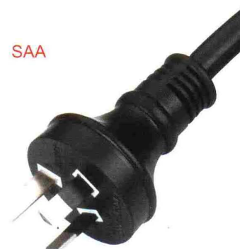
D06 澳大利亚插头 10A250V~ 4V-75 H05VV-F 3 × 0.75~1.5mm 2 4V-75 0.6/1KV 3 × 1.0~1.5mm 2 Q02462 AS/NZS 3112:2000
