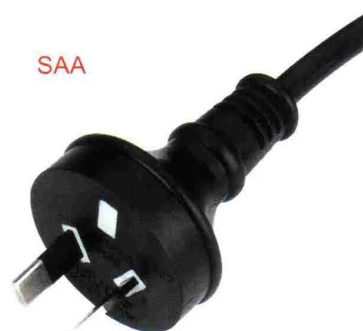
D05A/D05B 澳大利亚插头 D05A 7.5A 250V~ H03VVH2-F 2 × 0.5~0.75mm 2 D05B 10A 250V~ H05VV-F 2 × 0.75~1.5mm 2 Q02462 AS/NZS 3112:2000
